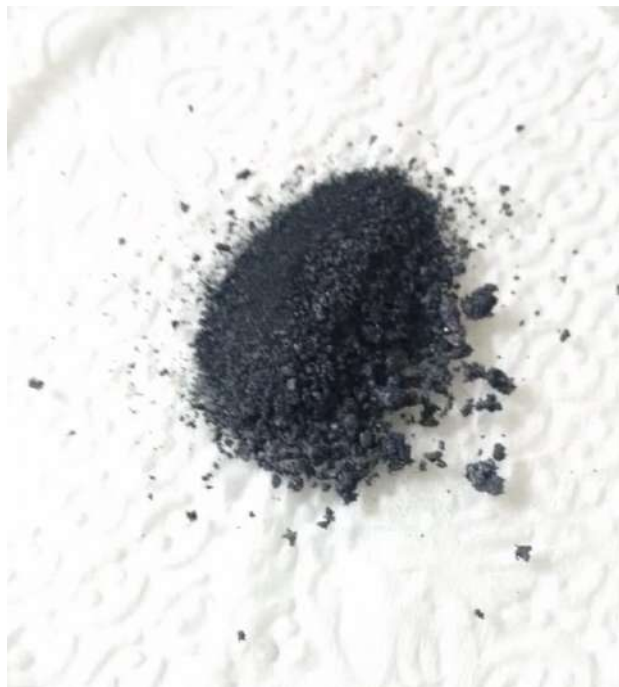
Figura 3.2: Material obtido na segunda etapa do método sol-gel, tratada termicamente em 1200°C por 2h.
