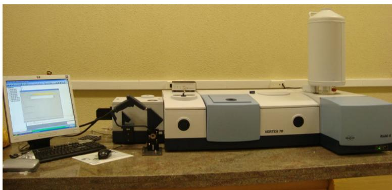
Figura 4.8: Espectrômetro de Infravermelho Distante
