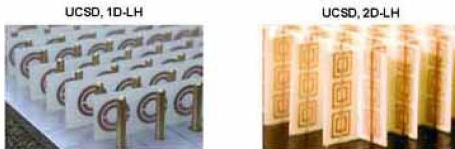
Figura 3.4: Metamateriais construídos com fios metálicos para produzir a resposta elétrica e SRRs para o efeito magnético. Adaptado de Pendry 2006 [2].
