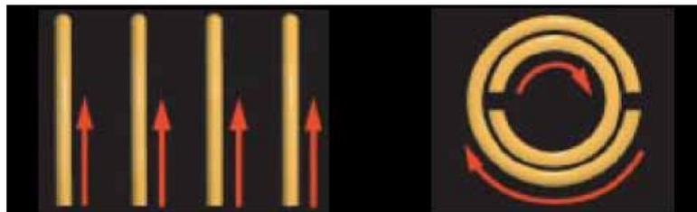
Figura 3.3: Os elementos básicos dos metamateriais de Pendry e Smith. Os fios de metal (esquerda) geram a permissividade elétrica, e os anéis partidos – SRRs –, a permeabilidade magnética. Adaptado de Pendry 2006 [2].
