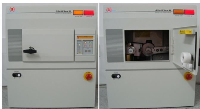
Figura 3.3: Difratômetro utilizado nas medidas de DRX - (a)Difratômetro fechado (b)Difratômetro aberto
