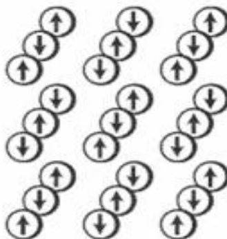
Figura 5: Alinhamento dos momentos magnéticos de um material antiferromagnético [16].
