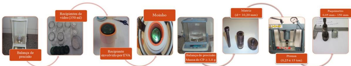
**Figura 14.** Procedimentos de fabricação das amostras.
