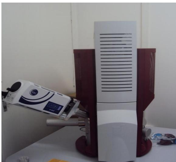
**Figura 26.** Microscópio Eletrônico de Varredura utilizado com EDS acoplado.
