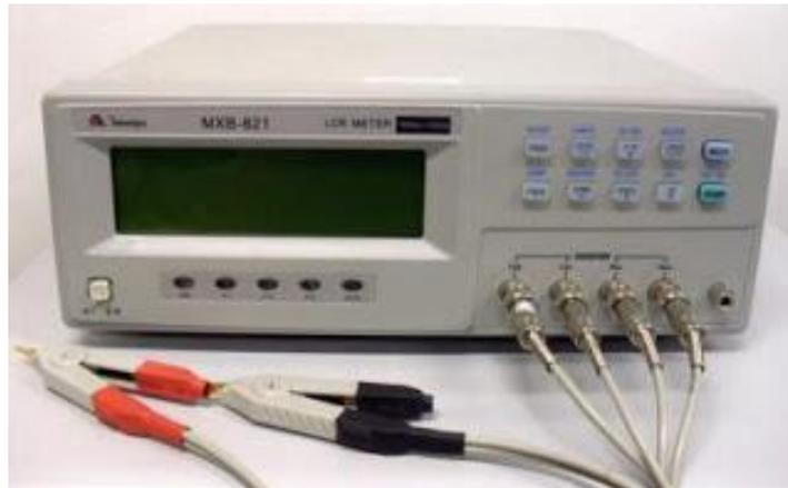
**Figura 29.** Ponte LCR de bancada utilizada. Fonte: <http://manuais-ctism.blogspot.com.br/2011/05/ponte-lcr-de-bancada-minipa-mxb-821.html>.
