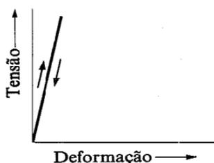
**Figura 7.** Relação elástica tensão-deformação. A deformação elástica é diretamente proporcional à tensão. Fonte: Vlack, 2000.
