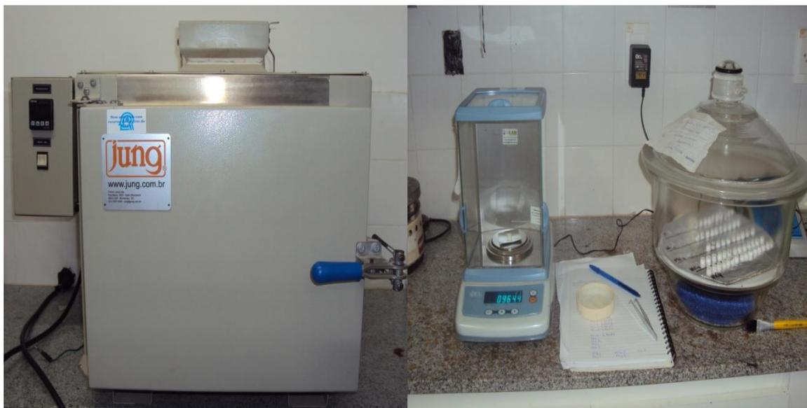
**Figura 25.** Forno utilizado na sinterização, balança e dessecador.
