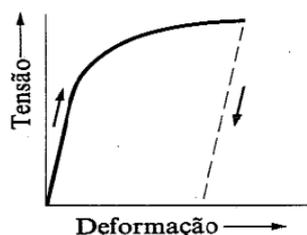
**Figura 8.** Relação plástica tensão-deformação. A deformação plástica que se segue à deformação elástica inicial não é reversível. A deformação elástica continua a aumentar durante a deformação plástica, mas é reversível. Fonte: Vlack, 2000.
