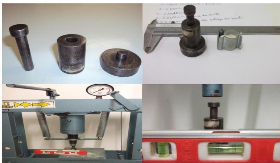
**Figura 24.** Molde, paquímetro e prensa hidráulica utilizada.
