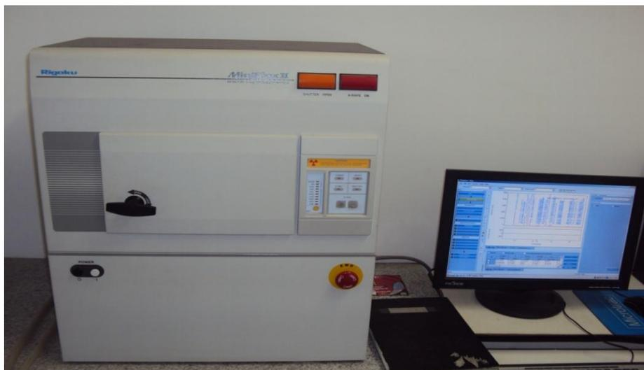
**Figura 20.** Difractômetro de raios-X utilizado.
