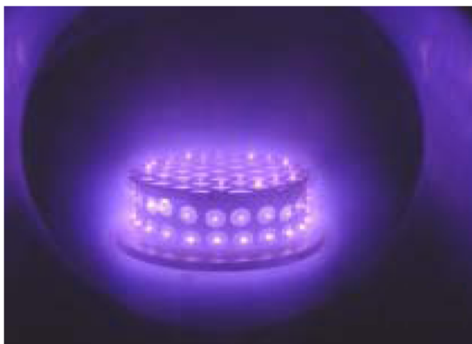
Figura 2.24 – Aspecto visual da formação do plasma na superfície da gaiola para uma pressão de trabalho p = 2,5 \text{ mbar} [15].
