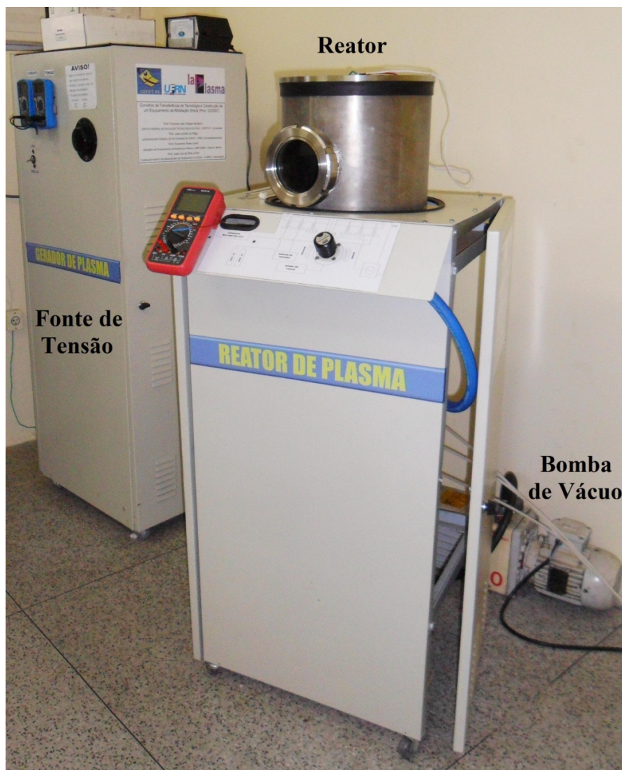
Figura 3.3 - Fotografia do equipamento de nitretação por plasma do Laboratório de Plasma do IFPI.
