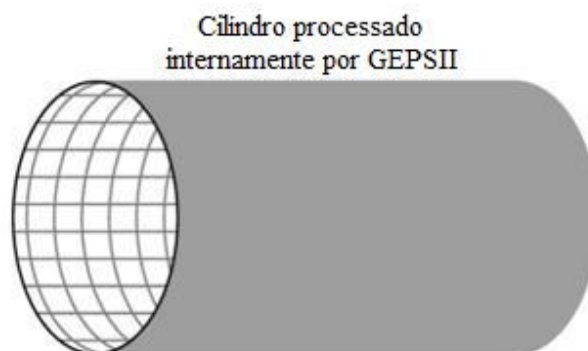
Figura 2.20 - Efeito grade sombra observado na superfície interna do tubo cilíndrico processado por GEPSII (as regiões das linhas da “grade” correspondem às regiões de sombra) [39].
