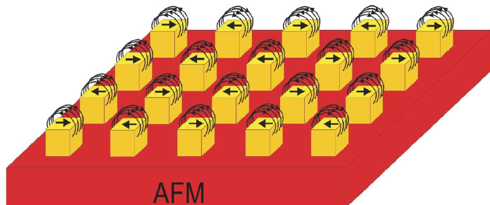
Figura 4: Arranjo de nanopartículas ferromagnéticas (FM) crescidas sobre um substrato antiferromagnético (AFM). Em evidência, o fluxo de campo magnético devido ao estado de magnetização da nanopartícula.
