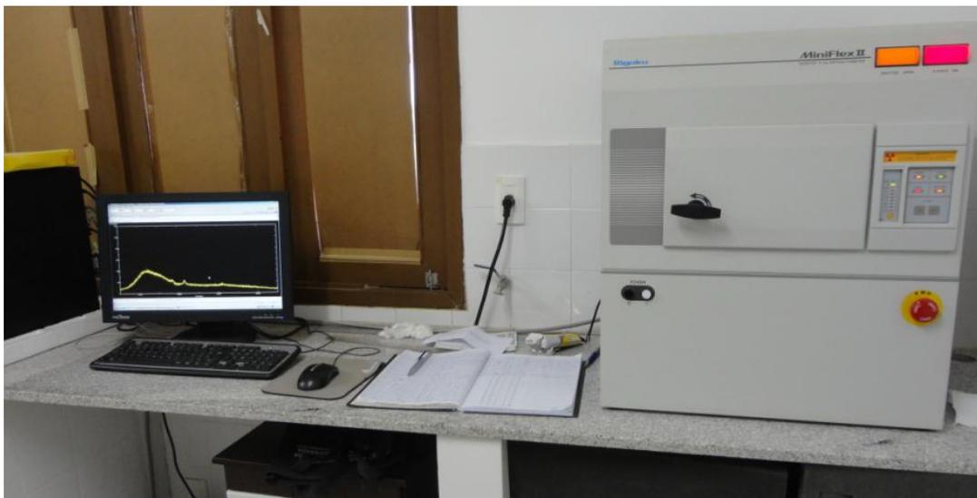
*Figura 3.10: Difratorômetro de Raios-X do LAMOp.*
