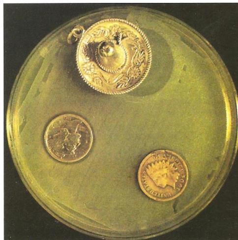
Figura 2.7.: Ação oligodinâmica dos metais, as zonas claras representam o inibição do crescimento bacteriano, o pingente e a moeda de cinco centavos norte-americanos, possui componentes de prata e a de um centavo contém cobre [23].
