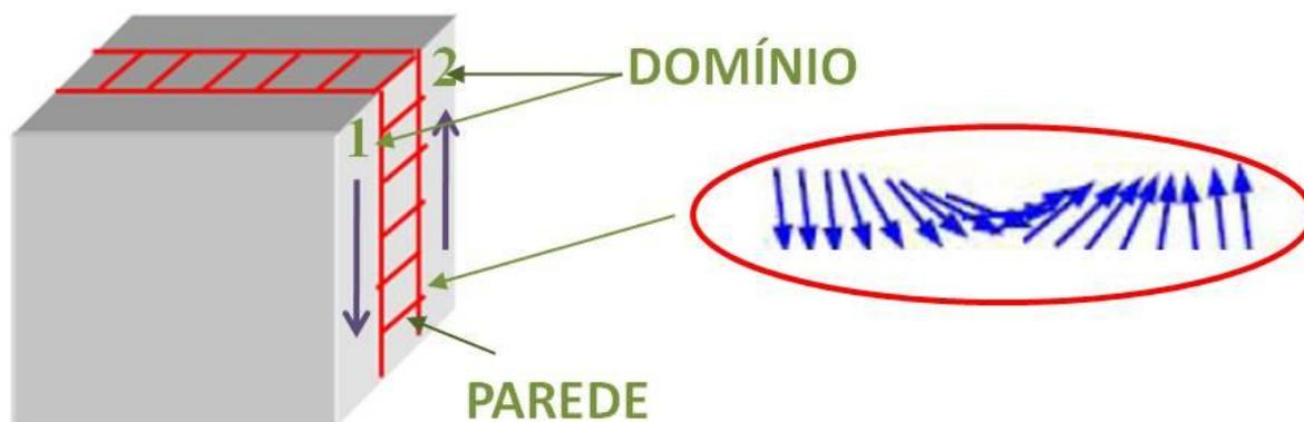
Figura 2.2: Ilustração referente a parede de domínio magnético separando dois domínios com magnetização antiparalela.
