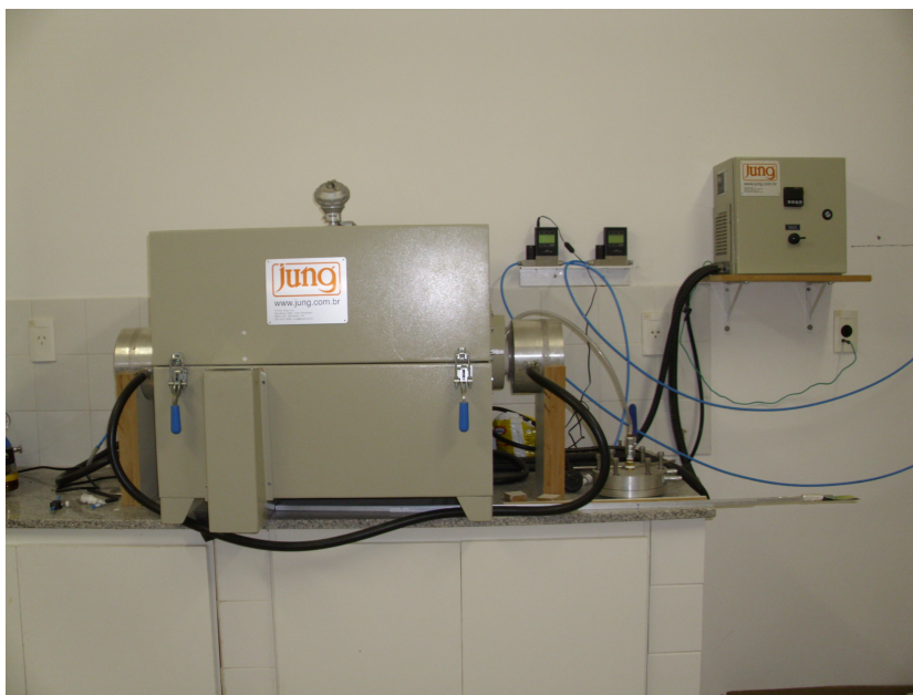
Figura 3.8: Forno Tubular ligado em atmosfera de Hidrogênio.
