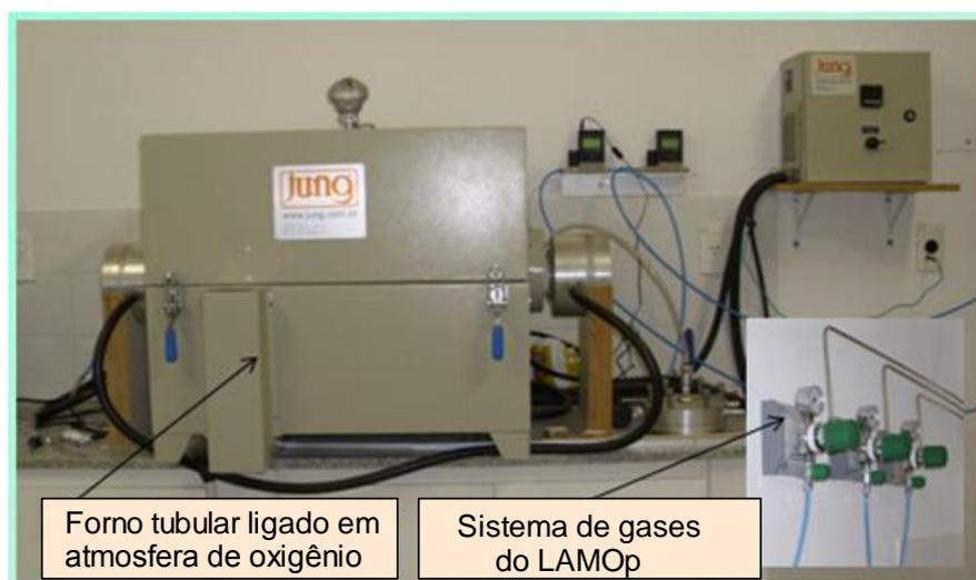
Figura 5.4: Forno tubular e o sistema de gases do laboratório.
