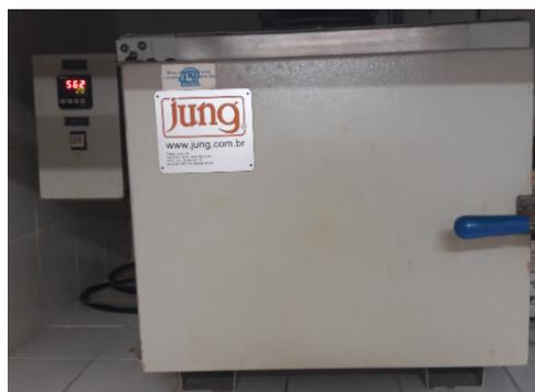
Figura 16: Forno tipo Mufla
