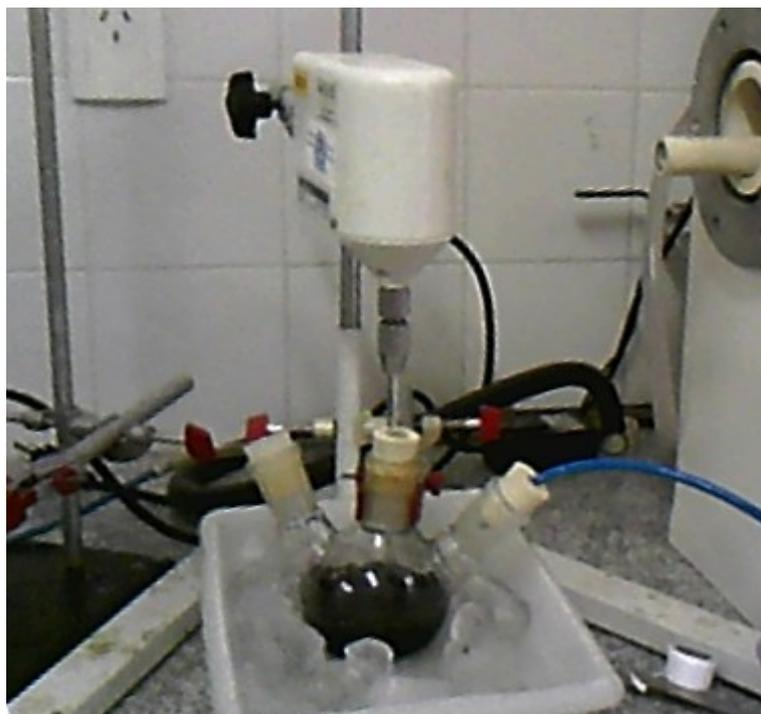
Deste modo o material ferro magnético foi obtido por redução química sob atmosfera de nitrogênio. Segue o provável mecanismo de reações químicas envolvido no processo [56]:
