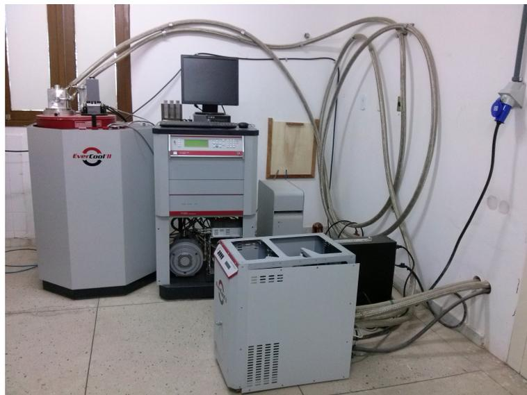
As medidas de magnetização podem ser feitas em função do campo magnético aplicado (no caso ciclos histereses), assim como em função da temperatura (zero-field-cooling (ZFC) e field-cooling (FC)).
